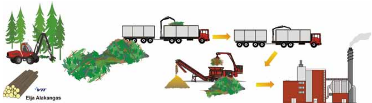
图 5.5 在终端设备切削松散型废弃物的木屑生产链
