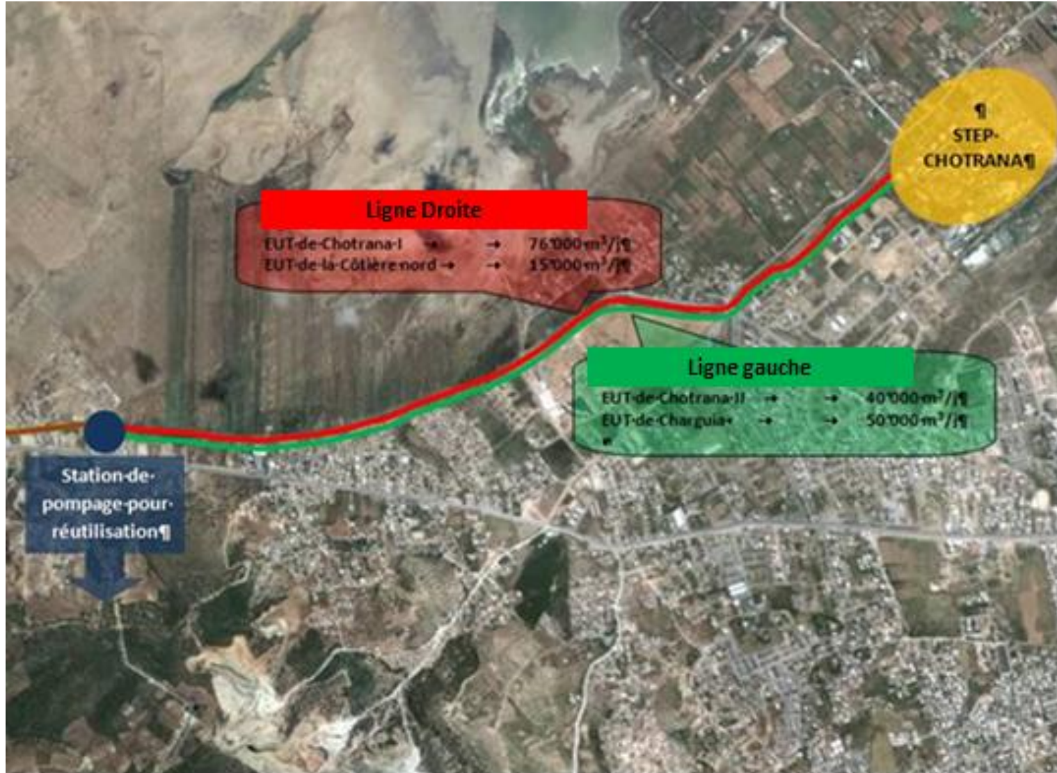
Figure 14.a: Bilan des rejets des EUE dans le canal El Khélij (tronçon n°1)
