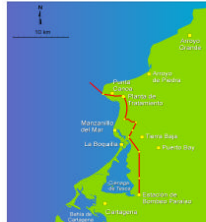
Gráfico 2. Tubería de efluentes y emisario
