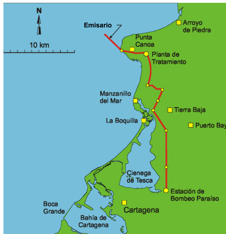
Gráfico 1. Emisario y sistema de alcantarillado de Cartagena
