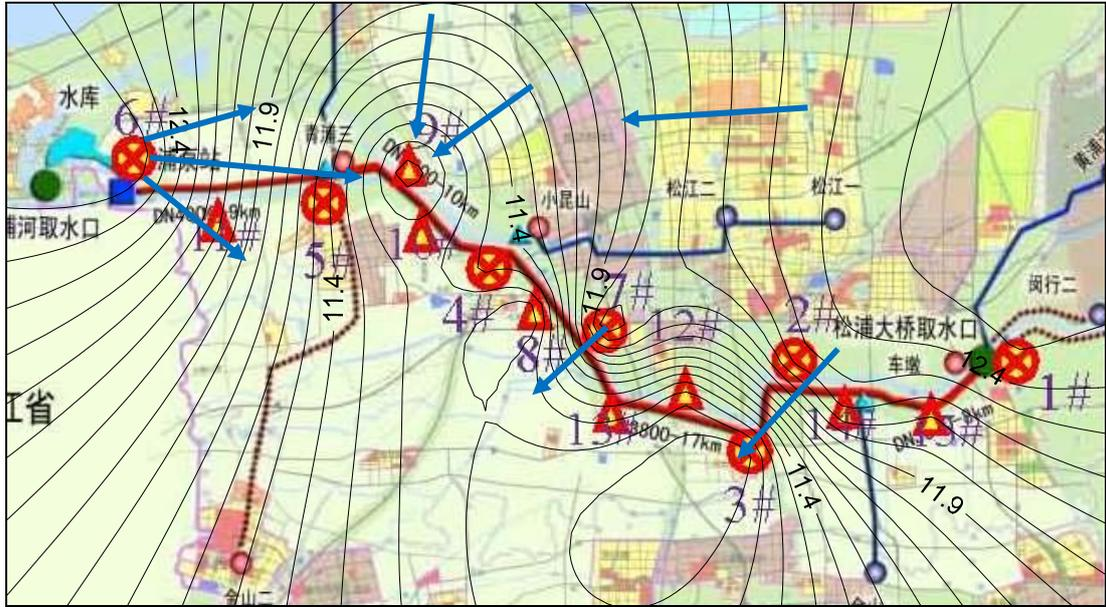
图 6.2-2 潜水层地下水流向图（平水期）
