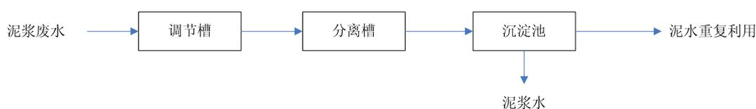
图 10.1-1 顶管施工泥浆循环处理工艺流程图
