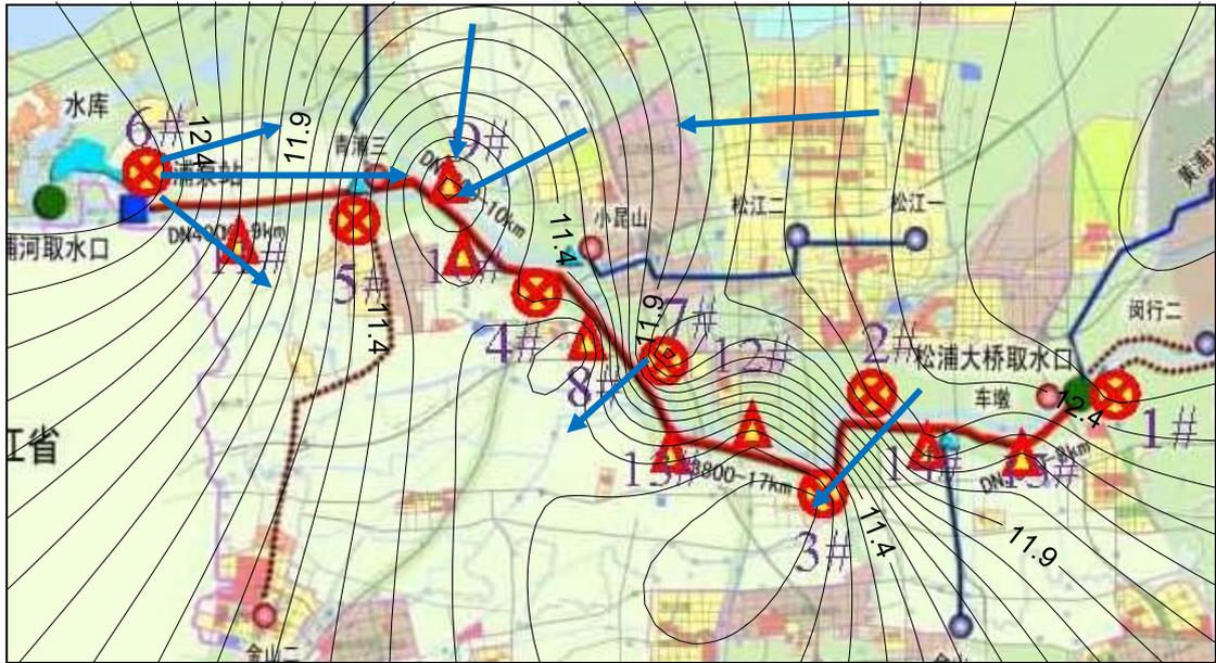
图 6.2-3 潜水层地下水流向图（丰水期）
