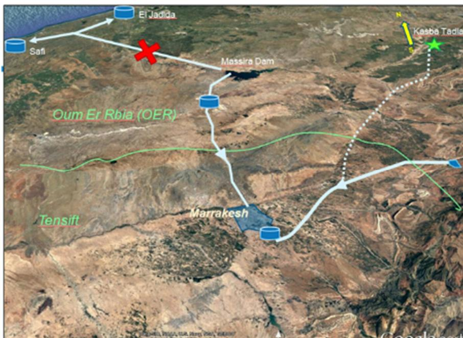
Figure XI-1: Schéma d'alternative avec dessalement d'eau de mer et transfert d'eau de Kasba Tadla à Marrakech (DS1)
