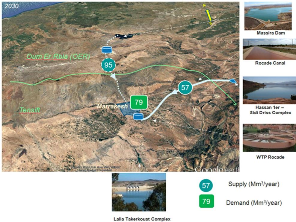
Figure XI-19: Schéma des ouvrages programmés d'alimentation en eau potable de la ville de Marrakech à partir du «Transfer Nord – Sud» via le barrage d'Al Massira (source : ONEE)
