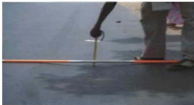
PHOTO 5 : AFFAISSEMENT HORS RIVES (RN2)
