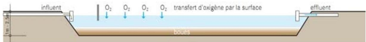
Figure 14. Schéma de fonctionnement d'un bassin de lagunage aérobie (selon Eawag-Sandec)
