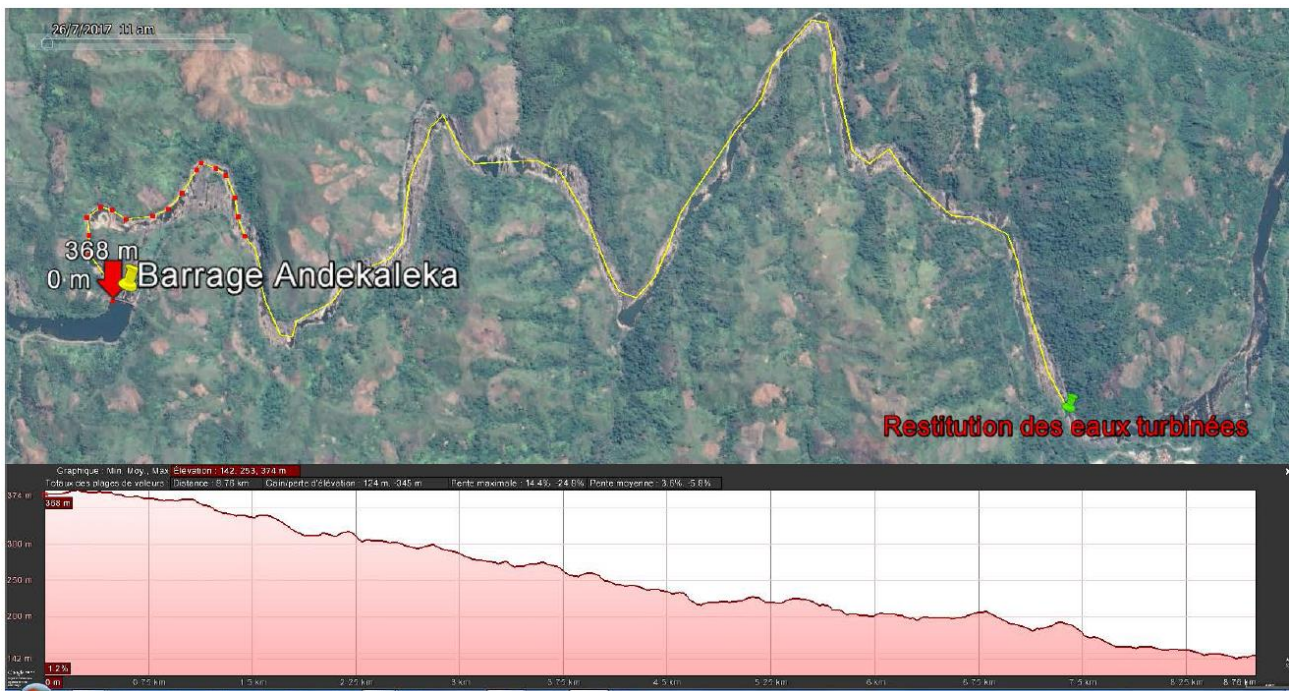
FIGURE 13 : PROFIL TOPOGRAPHIE DU COURS DE LA RIVIERE VOHITRA ENTRE LE BARRAGE ET LE POINT DE RESTITUTION DES EAUX
