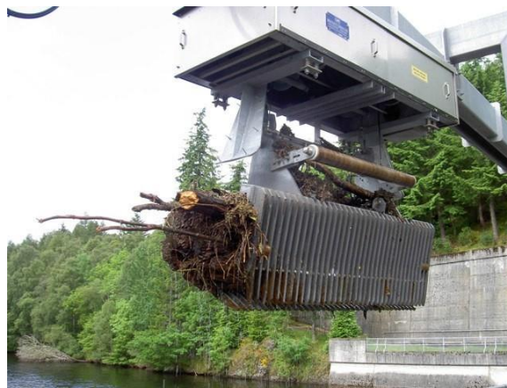
PHOTO 6 : TYPE DE DEGRILLEUR A INSTALLER AU BARRAGE D'ANDEKALEKA
