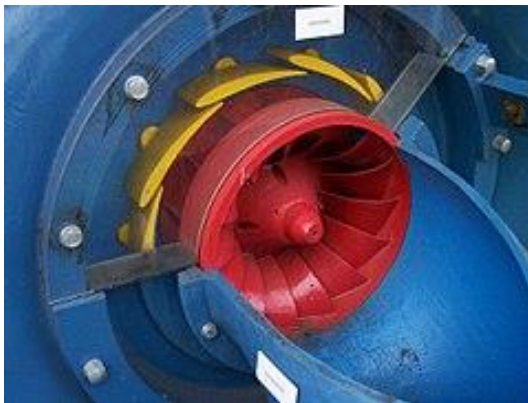
PHOTO 3 : DIRECTRICES, EN POSITION DEBIT MINIMUM
