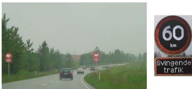
Figura 9. Panouri pentru viteze variabile în Danemarca - Indicator „Trafic fluctuant”
