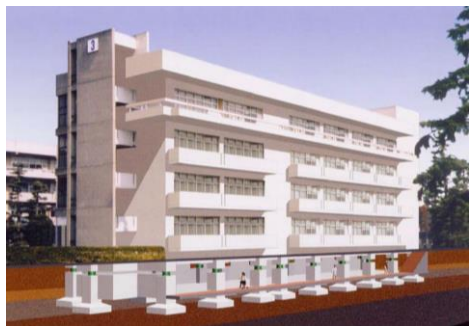
Figura 52. Schema de dispunere a sistemului de izolare la baza stâlpilor unei clădiri (stânga); dispozitive elastomerice dispuse sub stâlpi – Primăria municipiului București (dreapta)
