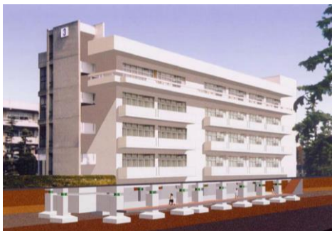
Figura 41. Schema de dispunere a sistemului de izolare la baza stâlpilor unei clădiri (stânga); dispozitive elastomeric dispuse sub stâlpi – Primăria municipiului București (dreapta)
