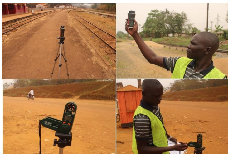
Photo 5: Mesure de la vitesse et de la direction du vent à Makondo et Minka
