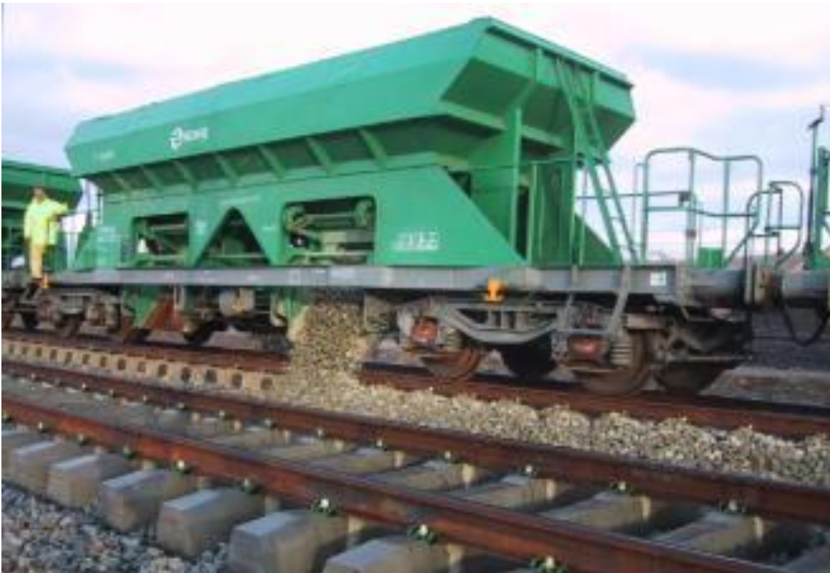
Photo 39 : Wagon trémie d'approvisionnement en ballast
