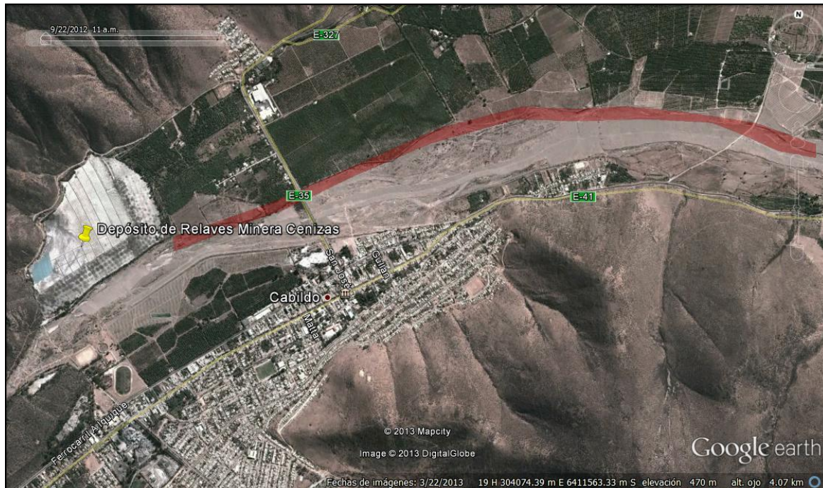
Figura 5.3.1.1b. Zonas demarcadas en rojo indican la necesidad de obras de defensa fluvial en Cabildo.
