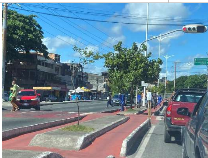
Figura 88 - Ciclovía R. Amazonas (Pituba) com largura de 1,12m contando com as faixas branca e vermelha de sinalização horizontal
