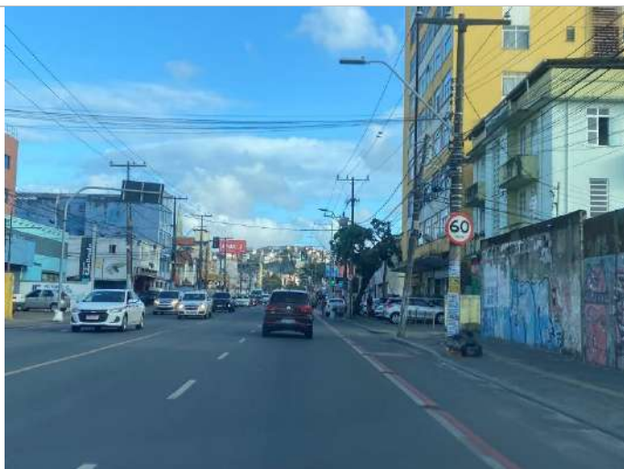
Figura 94 - Ciclovia na Av. Sete de Setembro (largura bidirecional de 1,80m, menor que a largura recomendável de 2,50m)
