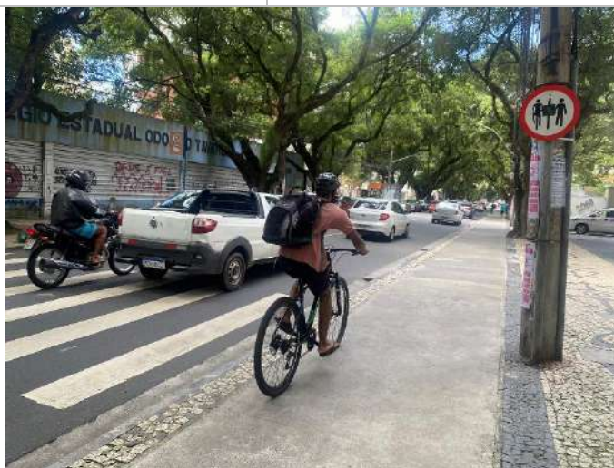
Figura 94 - Ciclovia na Av. Sete de Setembro (largura bidirecional de 1,80m, menor que a largura recomendável de 2,50m)
