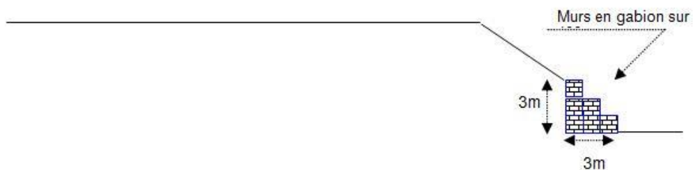
Figure 33 : Confortement du talus coté ravin par des murs en gabion
