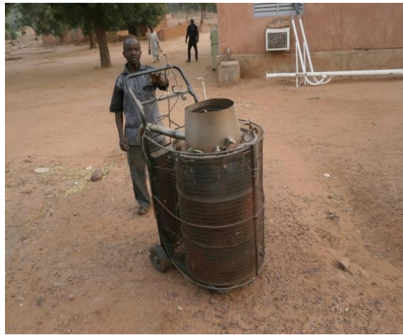
Incinérateur pour la destruction des déchets piquants à Konni
