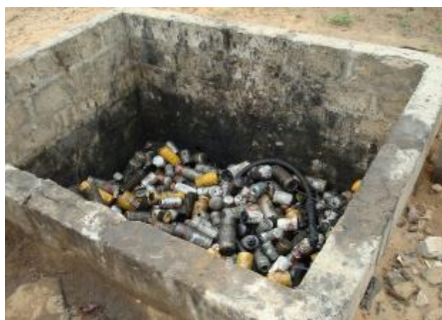
Photo 11: Exemple conditionnement correct d'huile usagée et de filtres à huiles mortes
