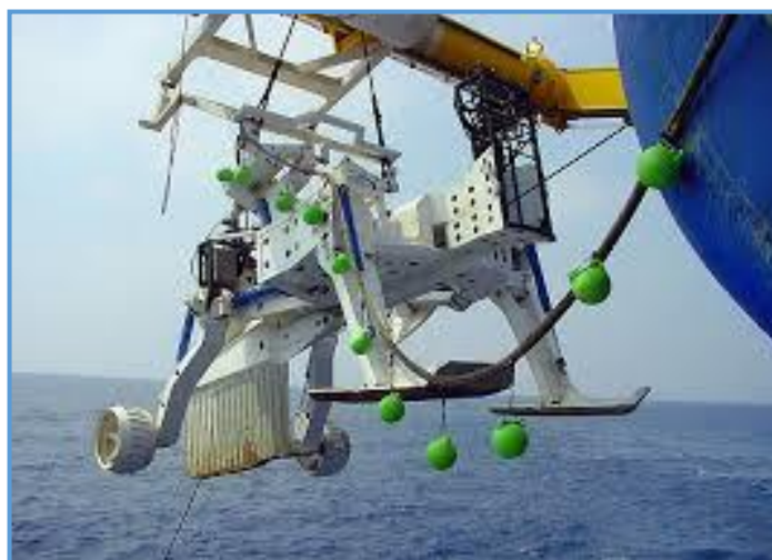
Photo 1: La charrue à soc qui permettra d'ensouiller le câble au fond de la mer
