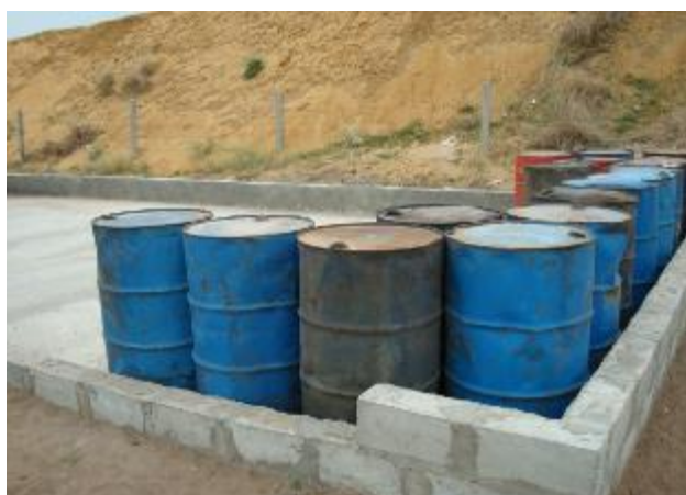
Photo 11: Exemple conditionnement correct d'huile usagée et de filtres à huiles mortes
