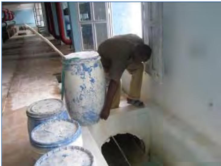
La solution est préparée et malaxée dans un bidon plastique à l'aide d'un bâton. Le débit de déversement de la solution dans le canal de transfert des eaux filtrée vers la bêche de reprise est empirique.
