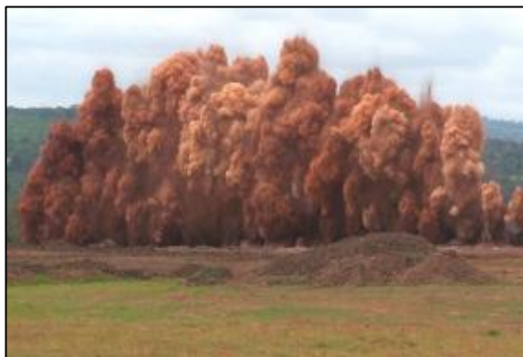
Figure 38 : Dynamitage pour abattage de la bauxite (Photo CBG).
