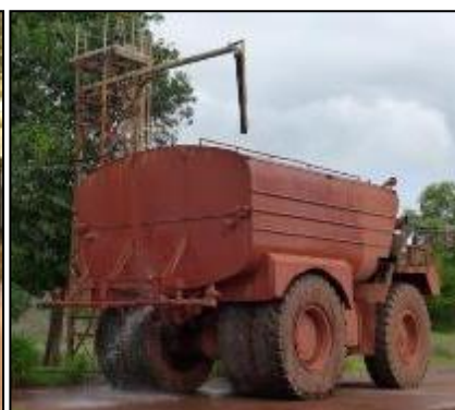
Figure 42 : Station de remplissage des camions arroseurs à la CBG
