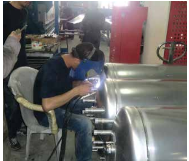
Production de chauffes eau solaire.
