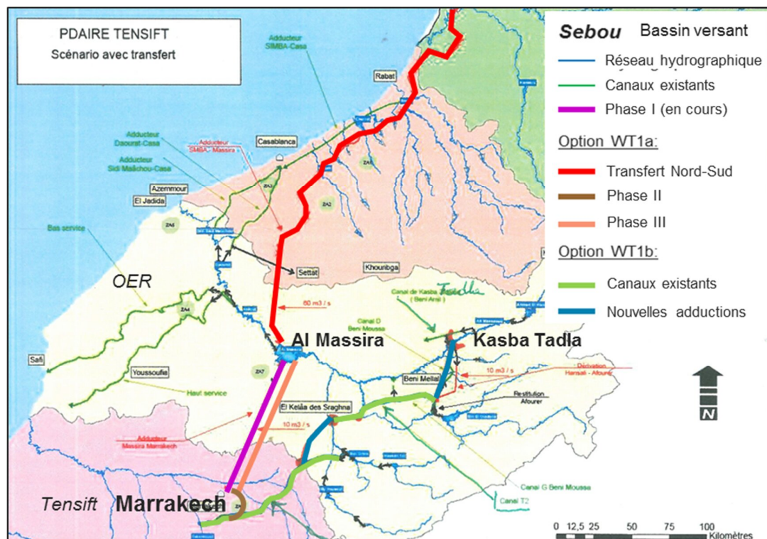
Figure 17 - Schéma des projets de transfert d'eau interbassins vers Marrakech via le barrage d'Al Massira ou le barrage de Kasba Tadla (source : PDAIRE Tensift)
