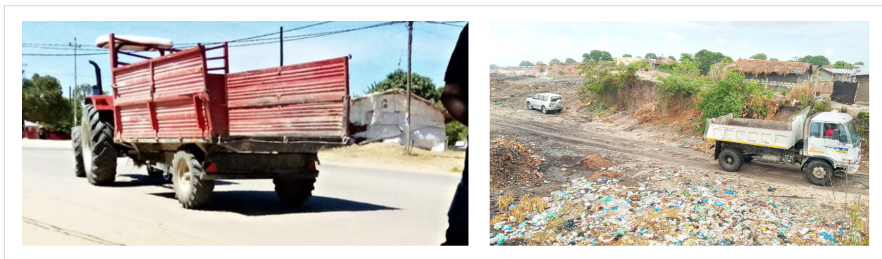
Figura 35 Exemplos de veículos abertos utilizados para a recolha de RS (tractor com atrelado e camião caixa aberta)
