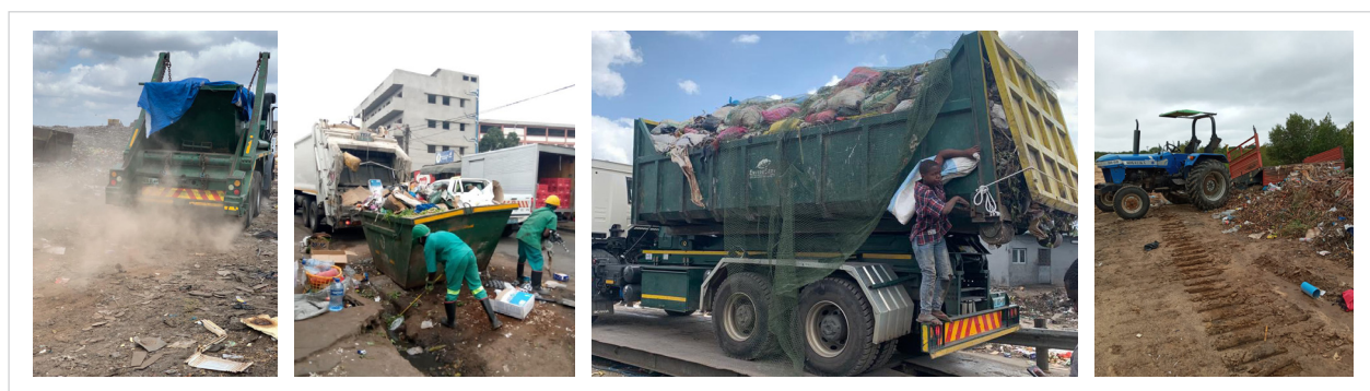
Figura 11 Veículos de recolha: Skip-loader, Compactador, Hooklift e Tractor com atrelado (Districto de Katembe)
