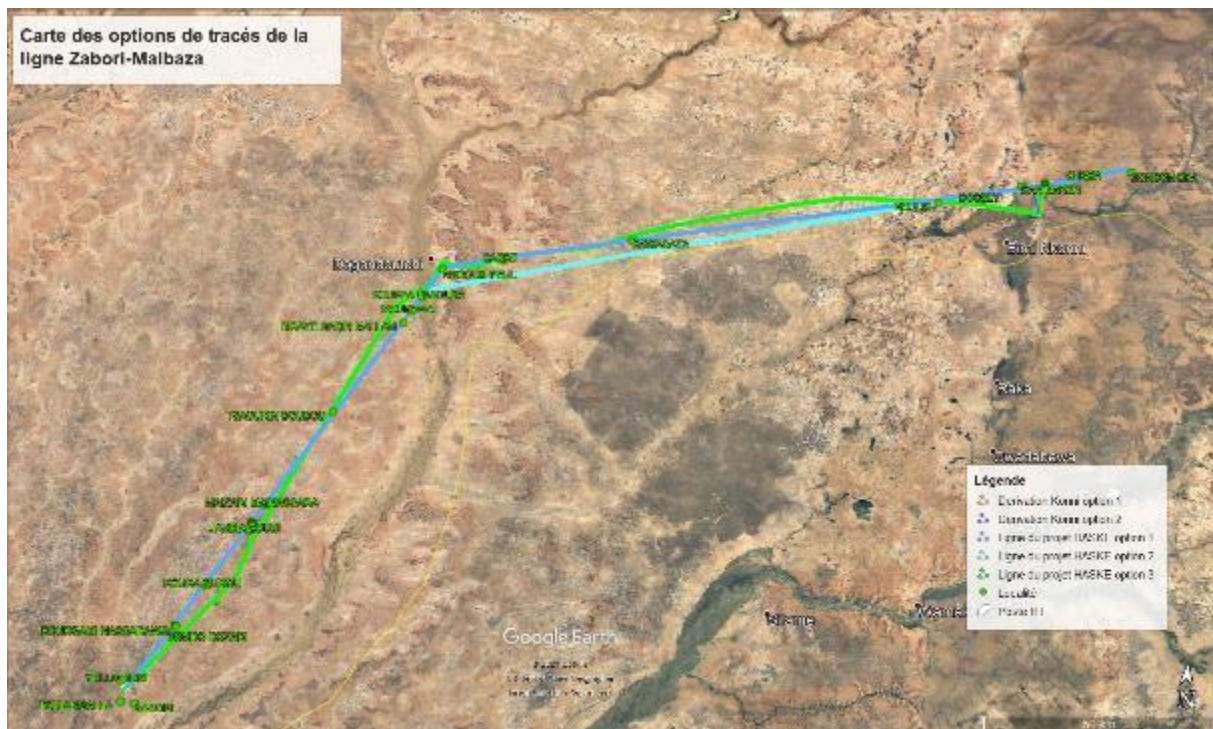
Figure 11: Options de tracé de la ligne d'interconnexion Zabori - Malbaza (Nigelec, 2021).
