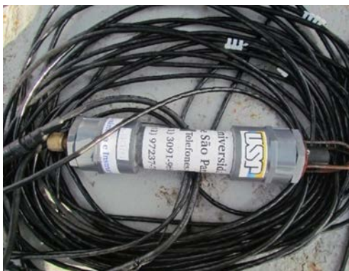
Figura 14 - Equipamentos utilizados para o monitoramento de ruídos subaquáticos durante as primeiras três campanhas.
