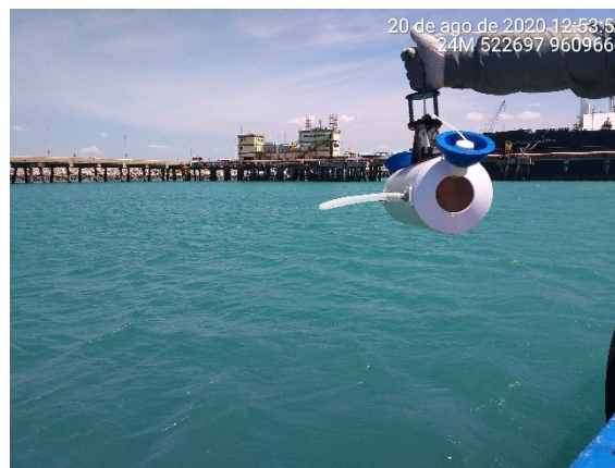
Figura 2 – Garrafa de Van Dorn para análises quantitativas.
