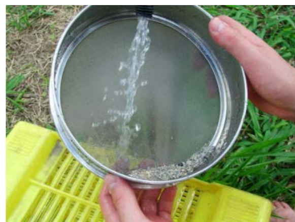
Figura 7 – Peneira para lavagem de amostras in situ .
