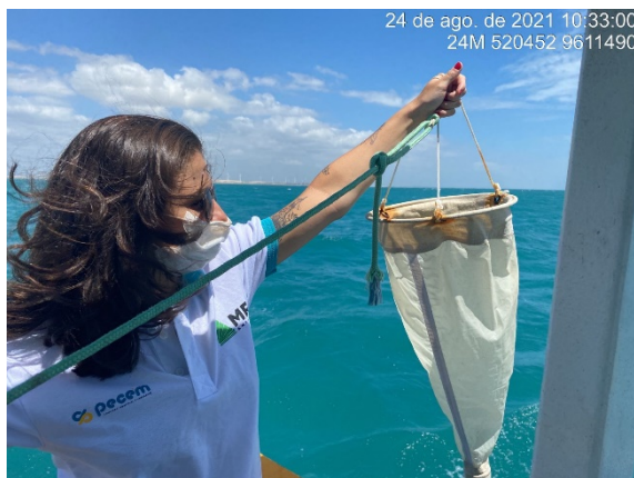
Figura 1 – Rede de coleta de plâncton cônica para análises qualitativas.
