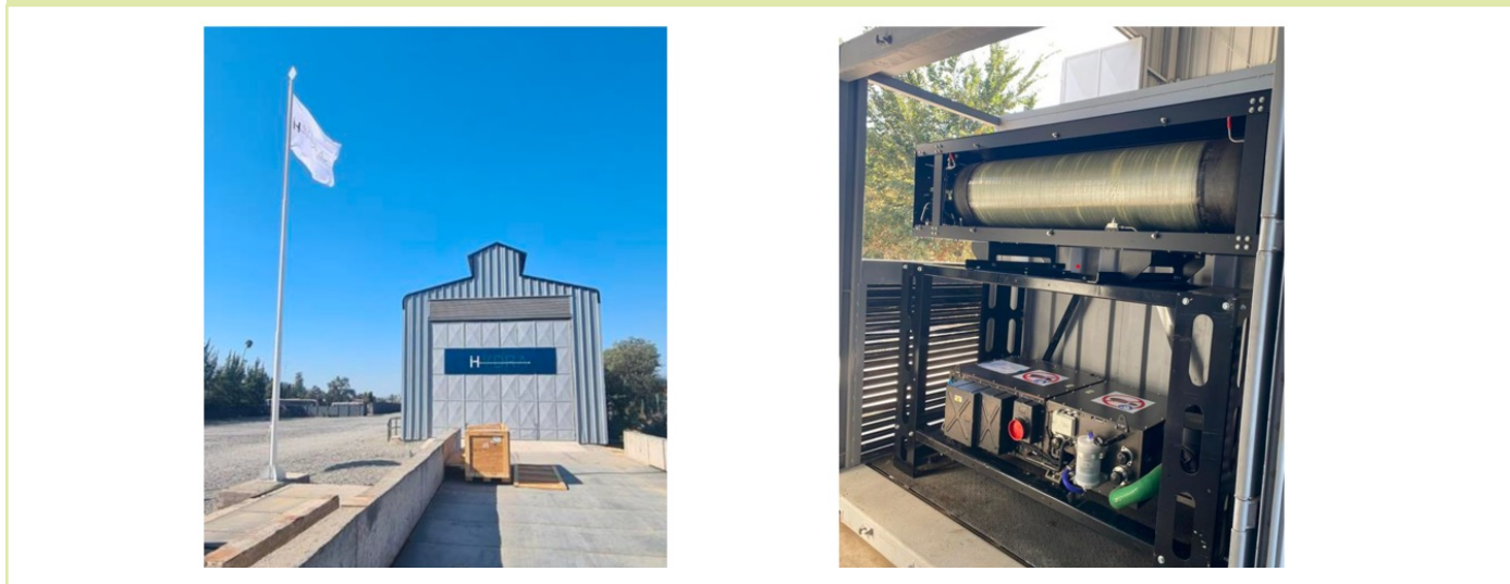
Figura 1-5 Instalación de integración de componentes del proyecto HYDRA y Celda de Combustible integrada al banco de prueba con su tanque de hidrógeno 34
