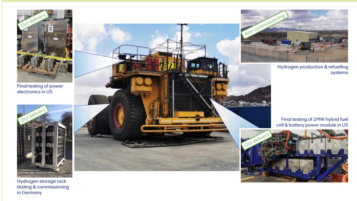
Figura 1-1 Subsistemas del CAEX FCEV y status de ellos en el sitio de pruebas en Mogalakwena 29
