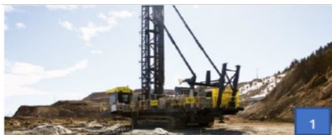
Figura 9-13 Principales equipos mineros: (1) perforadora, (2) pala de carguío, (3) cargador frontal, (4) tractor orugas, (5) tractor ruedas, (6) motoniveladora, (7) camión regador, (8) camión CAEX para el transporte de mineral.
