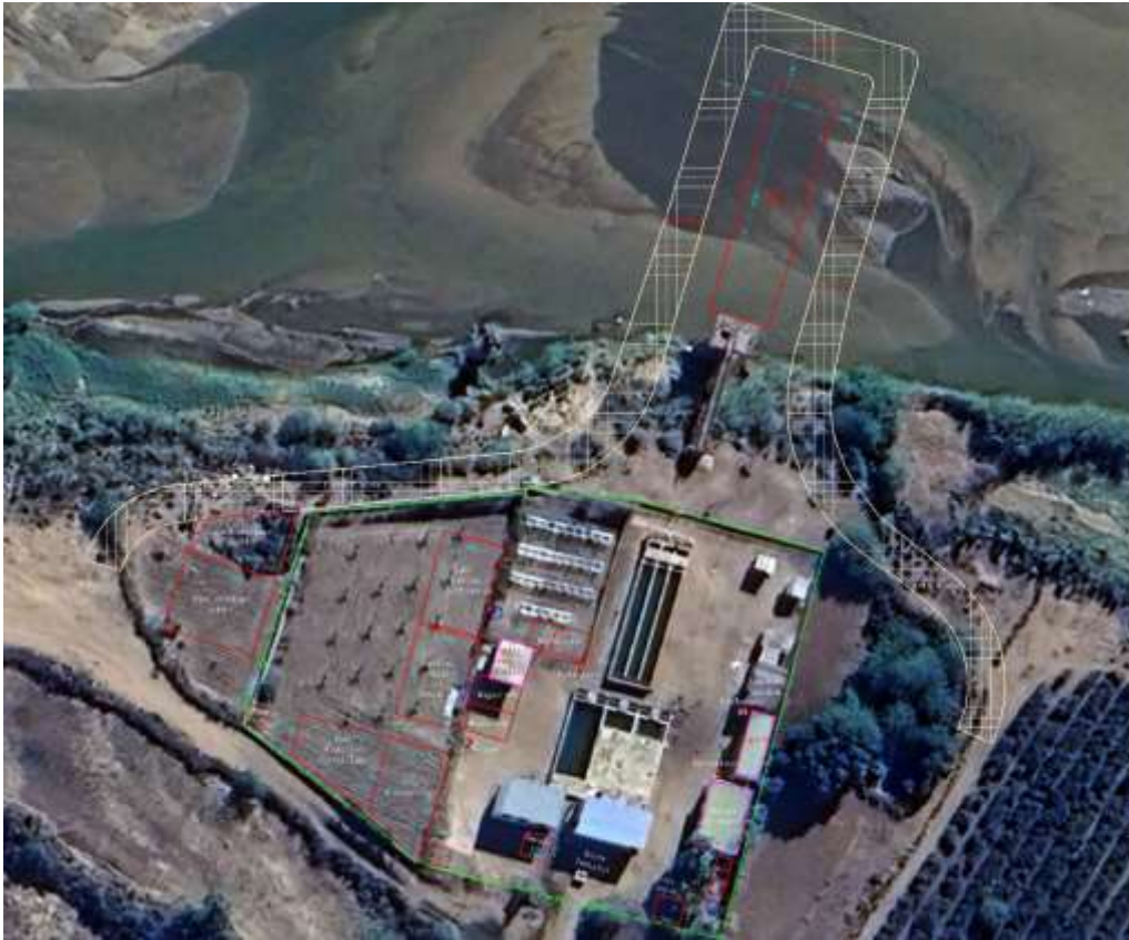
Carte 1 Présentation de l'emplacement du batardeau par rapport au lit mineur du fleuve
